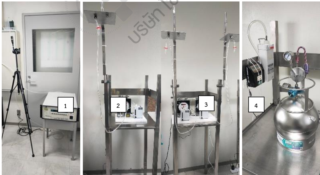
รูปที่ 2.6 แสดงเครื่องเก็บตัวอย่างอากาศ 1) ก๊าซไอโซน 2) สารปรอท 3) สารกลุ่มคาร์บอนิล และ 4) สารอินทรีย์ระเหยง่าย
